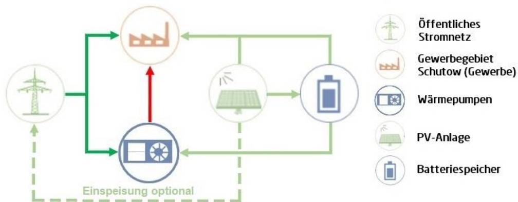
Abbildung 5.1 Stromversorgung Variante Handel
