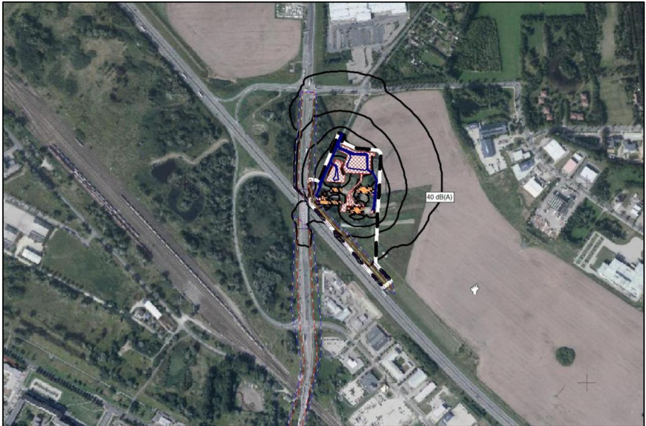
**Abbildung 7: Ergebnisse der Rasterberechnung für Zusatzbelastung durch gewerbliche Anlage im Geltungsbereich des B-Planes (Werktag 6:00 Uhr – 22:00 Uhr) BA2 Hochzeit**
