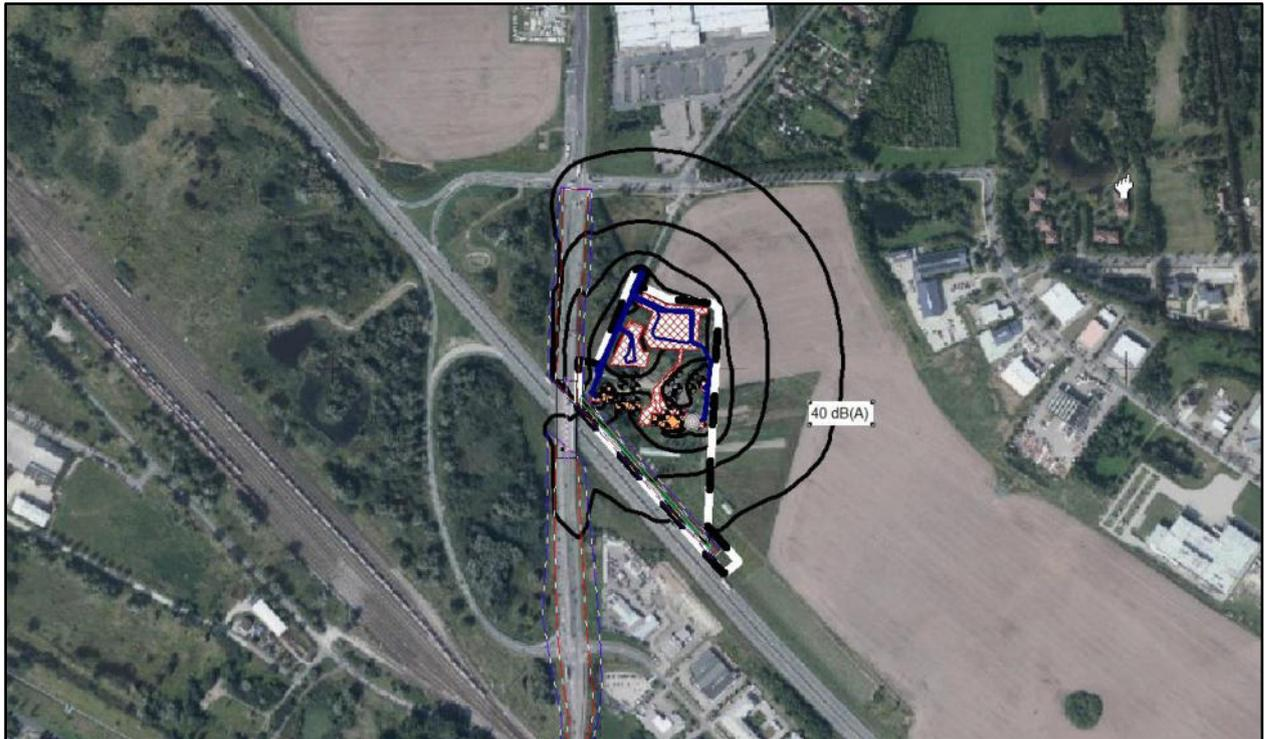
**Abbildung 8: Ergebnisse der Rasterberechnung für Zusatzbelastung durch gewerbliche Anlage im Geltungsbereich des B-Planes (Werktag 6:00 Uhr – 22:00 Uhr) BA2 Bistro**
