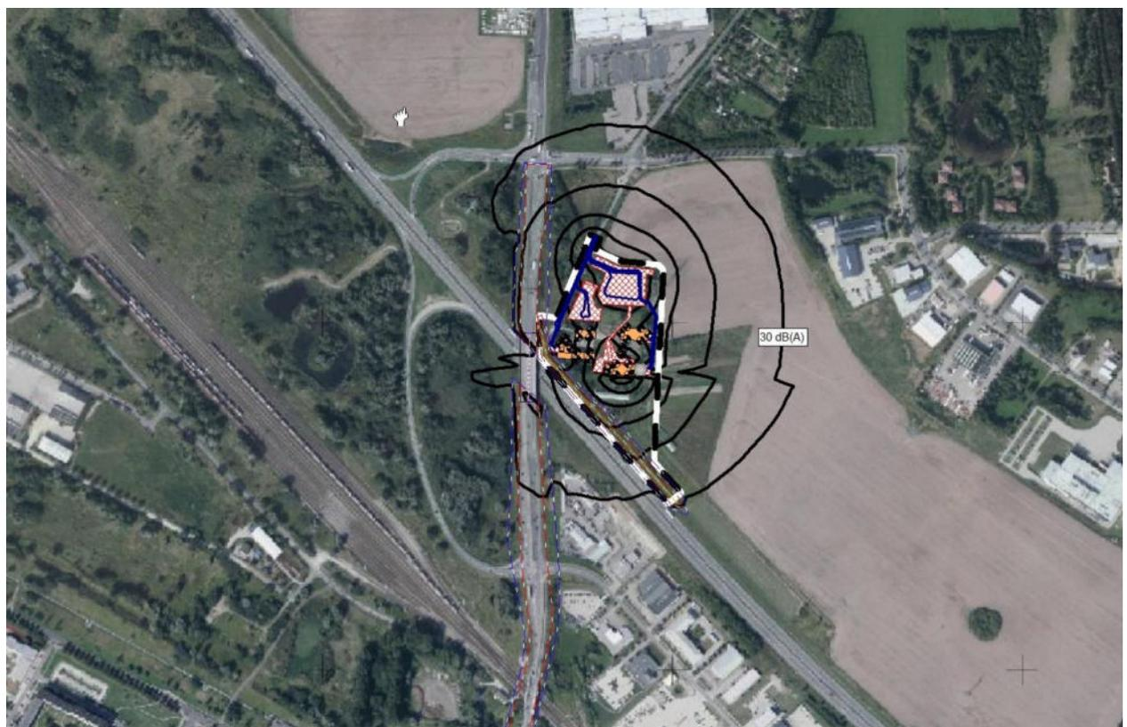
**Abbildung 6 Ergebnisse der Rasterberechnung für Zusatzbelastung durch gewerbliche Anlage im Geltungsbereich des B-Planes (Nacht 22:00 Uhr – 6:00 Uhr) BA2 Bistro**
