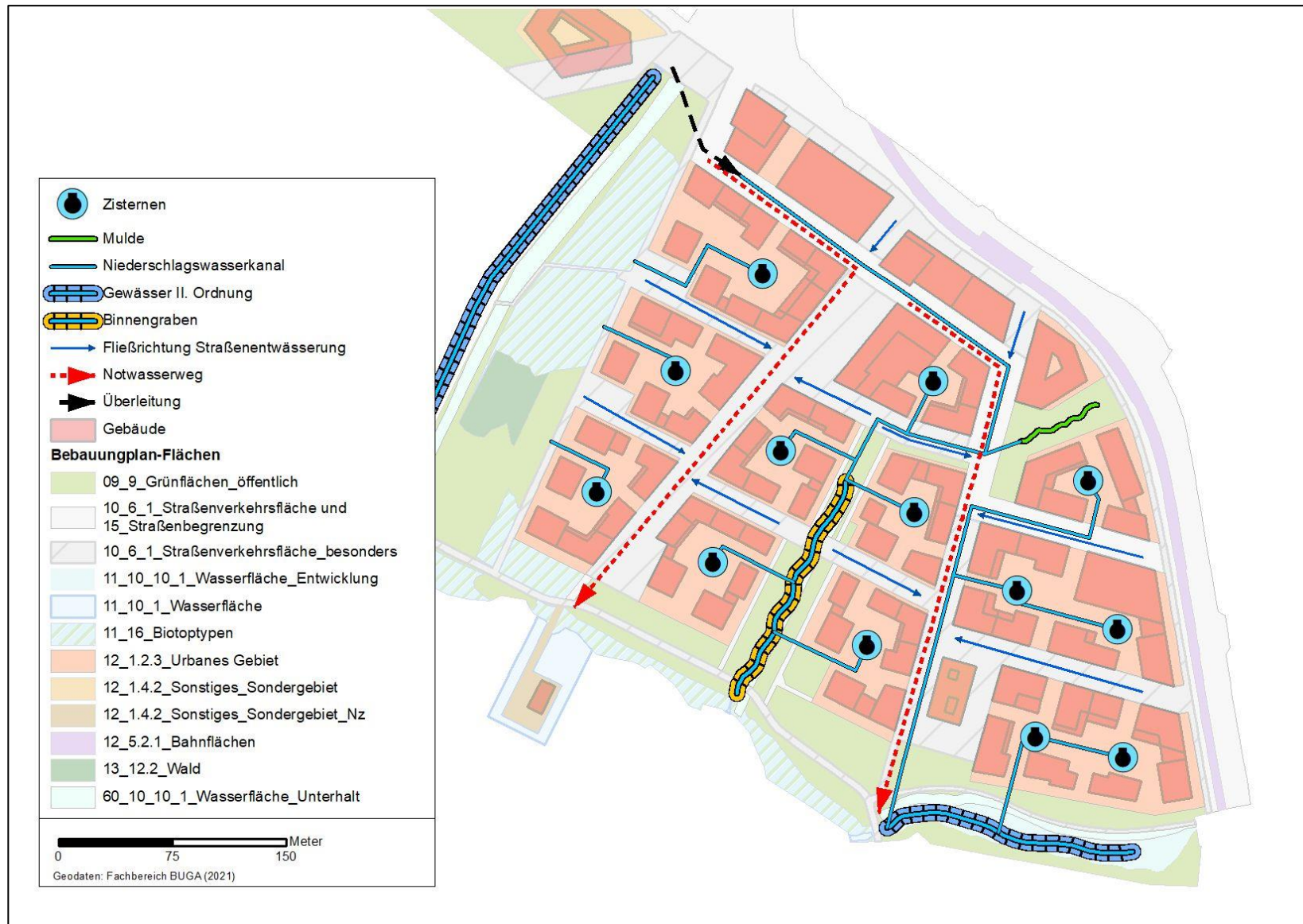
Abbildung 7-1: Grundsätzliches Entwässerungskonzept „Schwammstadt“ für das Bebauungsplangebiet Nr. 13.MU.204 "Warnow-Quartier, Dierkower Damm" – schematische Darstellung
