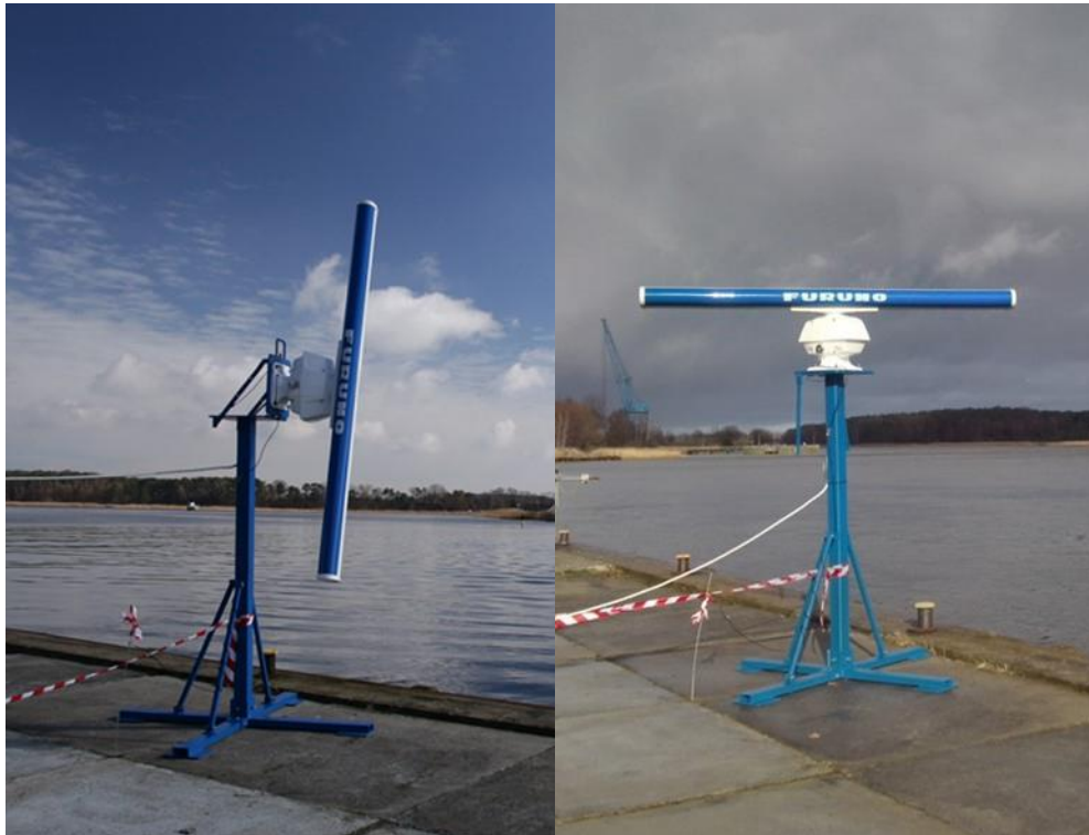
Abb. 4: Beispiel für ein Radargerät des verwendeten Typs im Vertikalbetrieb (links) und im Horizontalbetrieb (rechts).
