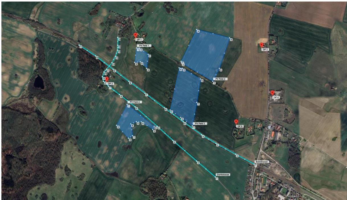
Abbildung 13: Anlage und Immissionsorte in der Simulationssoftware ForgeSolar
